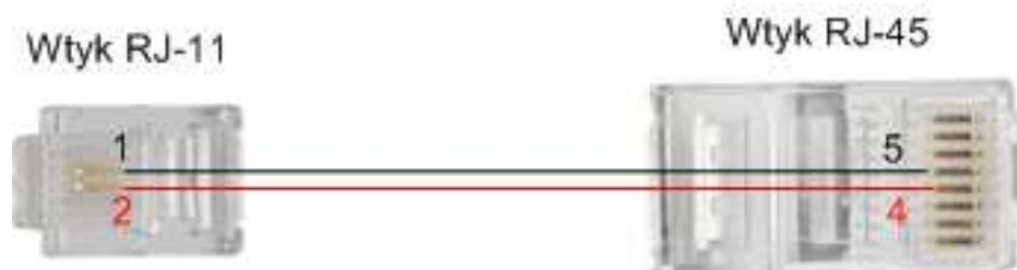
Przewód do podłączenia pulpitu dodatkowego do modułu manipulatora SDM4600.
