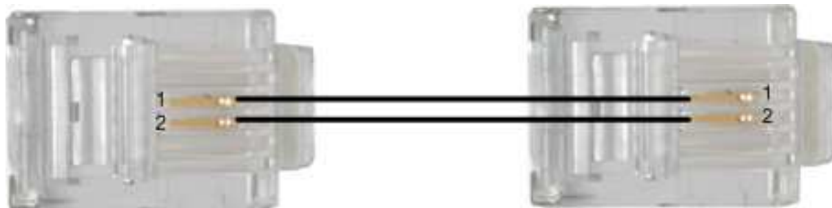
Rys. 5. Kabel łączący moduł nadawczo-odbiorczy z modułem manipulatora (1para – np. linia dzierzawiona)
