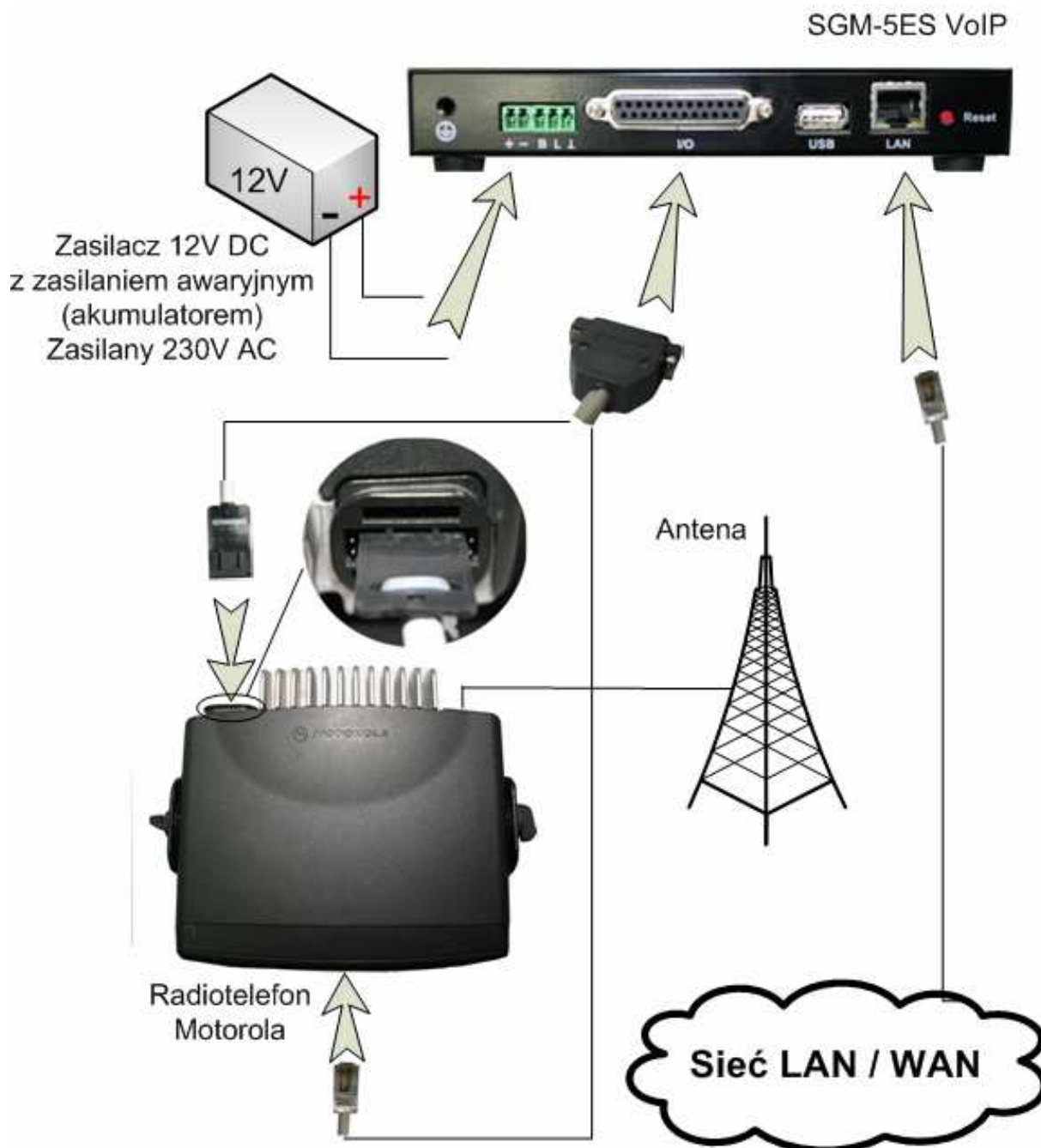
Sposób podłączenia urządzenia SGM-5ES.
