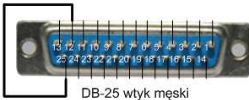
Rys. 10. Wtyk przygotowany do pracy modułu manipulatora z wewnętrznym głośnikiem
