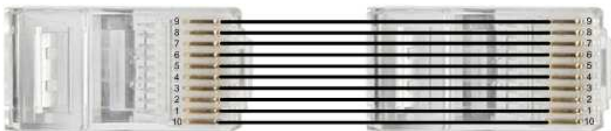
Rys. 9. Kabel łączący moduł manipulatora tylną częścią RLN (panelem przednim radiotelefonu – pyczczek) z modułem manipulatora
