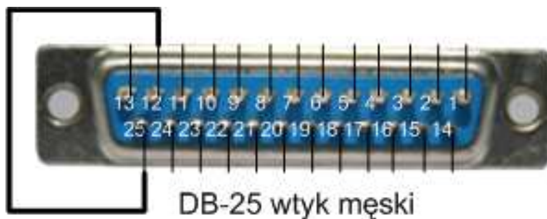
Rys. 22. Wtyk przygotowany do pracy modułu manipulatora z wewnętrznym głośnikiem
